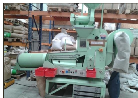
Figure 1 : Nettoyeur-séparateur mini PEKTUS ROHR 200
